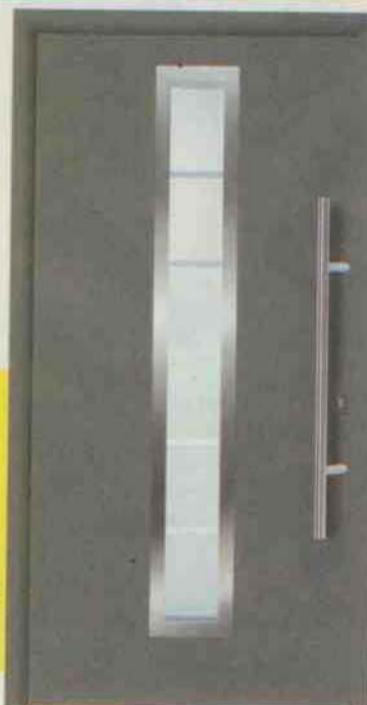
Vstupní dveře z ušlechtilé oceli ThermoPro mají vynikající tepelné izolační vlastnosti. Dveřní křídlo o tloušťce 46 mm je vyplněno touto polyuretanovou pěnou, má čtyřstranné dvojitě těsnění a kartáčové utěsnění ve spodní části dveřního křídla. Barevné provedení v různých odstínech, novinkou Titan Metallic. HÖRMANN
