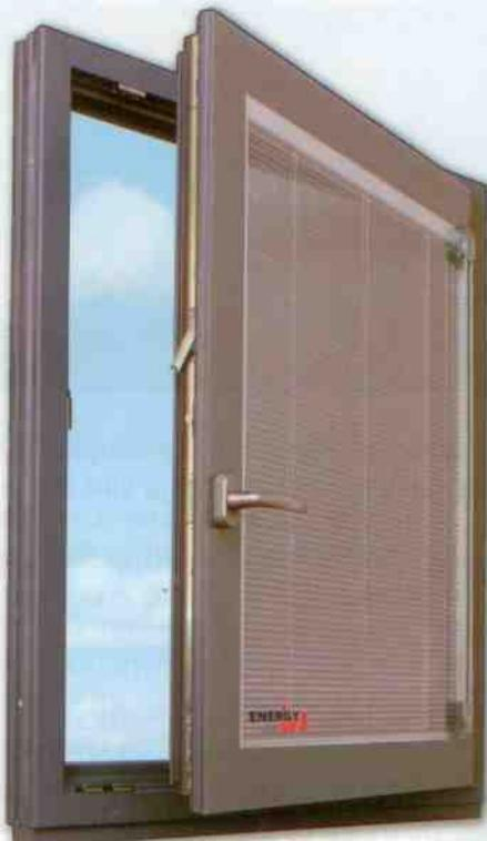
Originální způsob zasklení izolačním sklem INTERM ENERGY IN pochází z dílny společnosti Izolační skla, a.s. Designové ztvárnění interiérové strany: přesah skla maximálně potlačuje vizuální vjem vlastního rámu křídla. Navíc současné použití integrované meziskelní žaluzie s meziskelnou tepelnou fólií HEAT MIRROR umožňuje dosáhnout skvělých energetických parametrů ( $U_w$  0,8 až 0,9 W/m<sup>2</sup>K).
